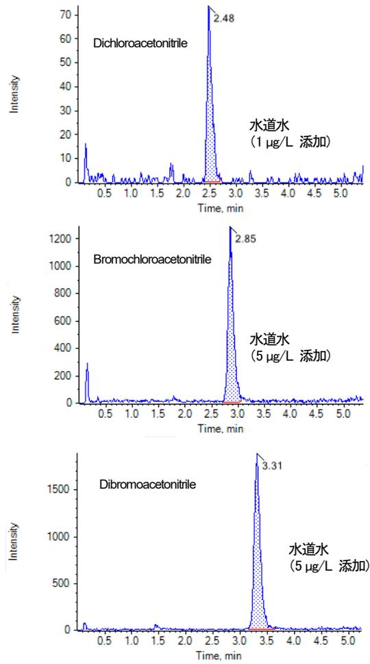
図3 水道水添加試料のクロマトグラム
